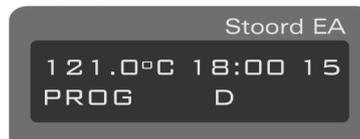
Ciclo para instrumental difícil de esterilizar, con cavidades profundas.
