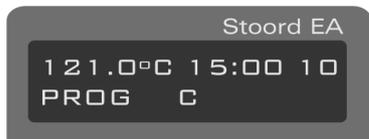
Para esterilizar líquidos. En este ciclo los 10 min. indicados son para despresurizar la cámara y evitar derrames de líquidos por una rápida despresurización.
