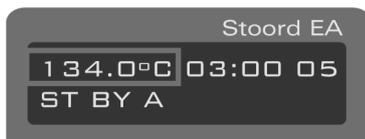
Al parpadear este valor usted podrá modificar con up /down la temperatura de esterilización llenando de 100 a 145°C. Una vez establecido presione prog. para la modificación de otro valor.
