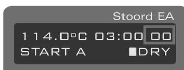
En **DRY despresurizar** la cámara de esterilizado durante 2 minutos, si hay tiempo de secado correrá a partir de este lapso reiniciando el contador indicado. En caso que no halla tiempo de secado programado finalizará el ciclo. Ver nota **previsualizar**.
