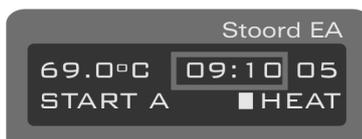
3- Presione **Start** y comenzará el ciclo seleccionado. Incrementando el contador **HEAT** (que se visualiza en el mismo lugar que el tiempo de esterilización) y subiendo la temperatura hasta alcanzar la temperatura programada.
