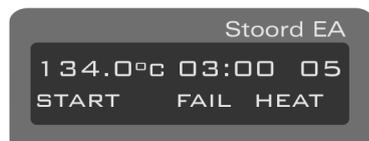
Indica que el proceso de calentamiento tardo mas de 25 min en llegar a la temperatura requerida. Se puede deber a la falta de agua o falla de una o mas resistencias. Presione **STOP** para detener la alarma y vuelva a comenzar con la secuencia desde el principio (pag. 9).
