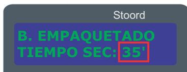
Modifique con up /down el tiempo de secado yendo de 0 a 60 min. Una vez establecido presione prog. para la modificación de otro valor.
