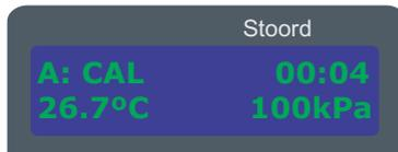
3- Presione **Start** y comenzará el ciclo seleccionado. Incrementando el contador **CAL**, contará el tiempo que tarda en llegar a la temperatura seteada. La temperatura, subirá hasta alcanzar la temperatura programada.
