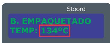
Al parpadear este valor usted podrá modificar con up /down la temperatura de esterilización desde 100 a 145°C. Una vez establecido presione prog. para la modificación de otro valor.
