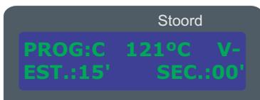
Para esterilizar líquidos. En este ciclo los 0 min. indicados son para despresurizar la cámara y evitar derrames de líquidos por una rápida despresurización.
