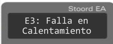
Los siguientes mensajes indican que falló el proceso de calentamiento. El problema puede ser por fallas en válvulas, fallas en resistencias de calefacción, fallas en etapa de potencia o por pérdida de hermeticidad. Debe presionar **STOP** para resetear, seguidamente ponganse en contacto con el servicio técnico.
