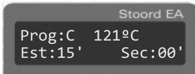
Para esterilizar líquidos. En este ciclo los 15 min. indicados son para despresurizar la cámara y evitar derrames de líquidos por una rápida despresurización.
