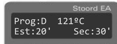
Ciclo para Instrumental difícil de esterilizar, con cavidades profundas.
