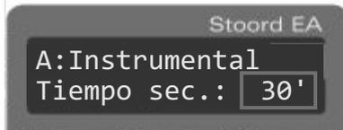
Por ultimo modifique con up /down el tiempo de secado llendo de 0 a 60 min. Una vez establecido presione prog. para salir guardando las modificaciones.
