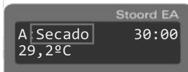
En **DRY despresurizara** la cámara de esterilizado durante 2 minutos, si hay tiempo de secado correrá a partir de este lapso reiniciando el contador indicado. En caso que no halla tiempo de secado programado finalizara el ciclo. Ver nota **previsualizar**.
