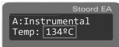
Al parpadear este valor usted podrá modificar con up /down la temperatura de esterilización llendo de 100 a 145°C. Una vez establecido presione prog. para la modificación de otro valor.
